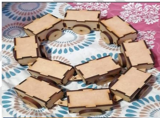
Imagen 6. Estructura utilizada para simular el cuerpo del milpiés. Fuente propia
