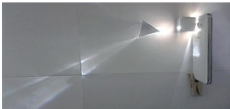
Figura 1. Disposición de la linterna, colimador y prisma
