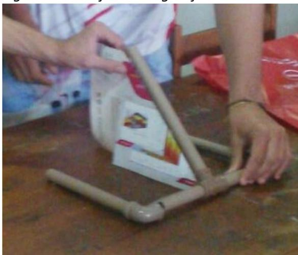
Com as etapas acima executadas pela equipe foi finalizada a construção do protótipo. Utilizando a primeira base de lançamentos, em forma de “U”, o foguete foi posicionado e foram efetuados lançamentos. Conforme previsto na etapa de montagem, a base apresentou problemas de vazamentos. A despressurização
