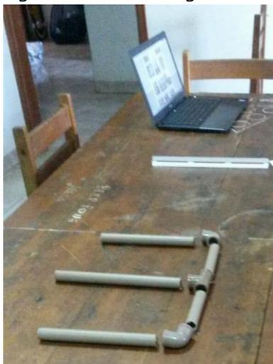
Para auxiliar na fixa o das conex es utilizaram uma cola espec fica para tubos de PVC pois, anteriormente, observaram que, provavelmente, apenas encaixar os tubos n o seria suficiente para suportar os n veis de press o previstos para aplica o no sistema. Conforme apresentado na Figura 1 foram colocadas as
