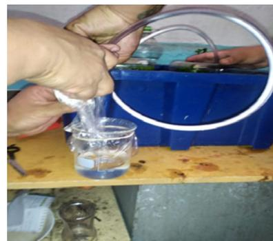
**Figura 1.** Producción y almacenamiento de dióxido de carbono.
